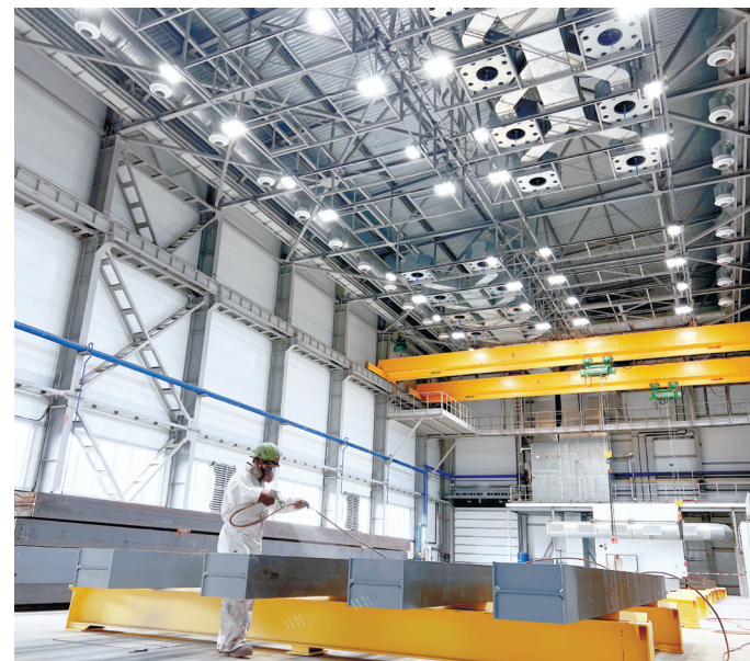
Снижение энергопотребления покрасочного участка до 70% по сравнению с окрасочными камерами
