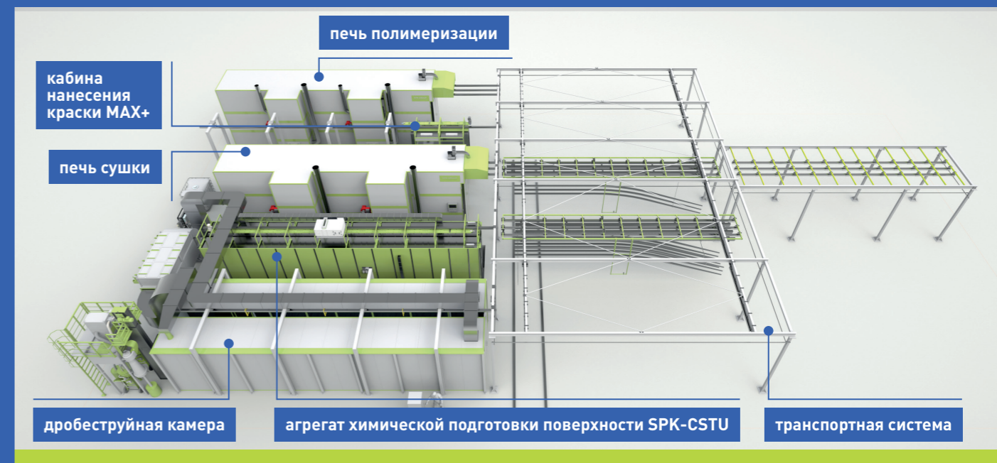
Линии с химической и дробеструйной подготовкой поверхности и обитаемой кабиной окраски
