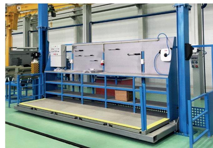
Лифтовая площадка SPK для монтажных работ
